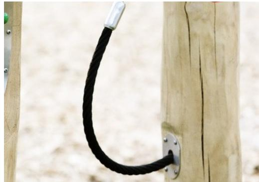
绳索由防紫外线的 PA 制成，并带有内部钢缆增强件。钢丝绳经过感应处理，以在钢丝绳和钢丝绳之间建立牢固的连接，从而导致良好的耐磨性。
