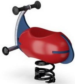
Der Sitz besteht aus recycelbarem PE mit einem Anteil von 33 % Post-Consumer-Materialien und ist in einem Stück formgepresst (Mindestwandstärke von 5 mm). PE hat eine hohe Schlagfestigkeit über eine grosse Temperaturspanne, was Vandalismussicherheit an allen Standorten gewährleistet.
