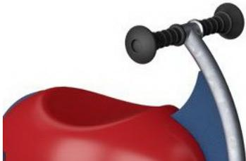
Griffe werden mit einer geformten PP-Inneneinlage und einer Außenschicht aus weichem TPV-Gummi hergestellt. Die Griffe sind mit einer Einlage aus verzinktem Stahl am Rohr befestigt, um Festigkeit und Haltbarkeit zu gewährleisten.
