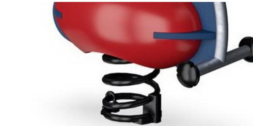
KOMPAN Federn bestehen aus hochwertigem Federstahl nach EN 10270-1. Die Federn werden durch Phosphatierung gereinigt, bevor sie mit einer Epoxid-Grundierung und Polyester-Beschichtung überzogen werden. Die Federn werden mit speziellen Klemmschutz-Elementen angebracht, um für höchste Sicherheit und eine hohe Lebensdauer zu sorgen.
