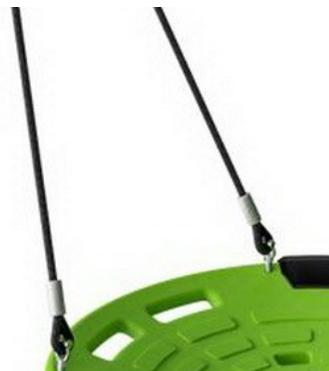
Le corde sono realizzate in PA stabilizzato ai raggi UV con rinforzo interno in acciaio. La corda è trattata con induzione al fine di creare una forte connessione tra acciaio e corda che porta ad una buona resistenza all'usura.
