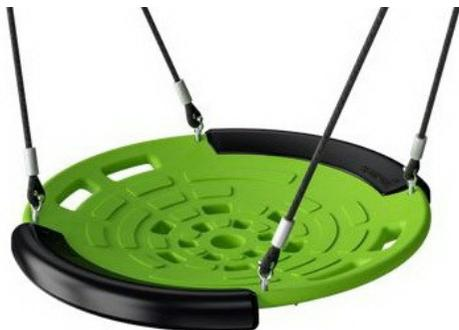
La scocca è realizzata in polietilene (PE) riciclabile al 100% e stampata in rotazionale in un unico pezzo. Il sedile è progettato con grandi aperture esterne per le maniglie e fori centrali per il drenaggio di acqua e sporco. Le quattro funi sono fissate con staffe in acciaio zincato a caldo per garantire una lunga durata.
