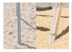
Le poteau des balançoires est disponible en version à cheviller avec des boulons d'expansion ou à enterrer à 60 cm ou 90 cm de profondeur. Les pieds en acier galvanisé à chaud sont ancrés directement dans le sol. Les poteaux en bois de pin sont surélevés par rapport au sol grâce à une conception unique de pied en acier galvanisé à chaud.
