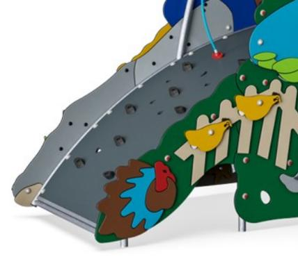
Le mur d'escalade incurvé est fabriqué à partir d'un panneau Ekogrip® qui se compose d'une base de PE de 15 mm d'épaisseur avec une couche de 3 mm de caoutchouc souple pour un effet antidérapant.
