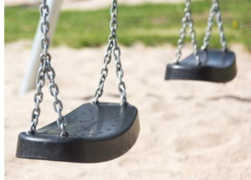
Die Standard-Sitze der KOMPAN Schaukeln sind so konstruiert, dass sie höchste Sicherheit und Beständigkeit bieten. Der Zwei-Komponenten-Sitz mit einem PP-Innenkern und einer Außenbeschichtung aus Gummi wird in einem Arbeitsgang hergestellt. Die Schaukelsitze sind mit Schaukelketten aus feuerverzinktem Stahl oder aus rostfreiem Stahl und für alle Schaukelhöhen erhältlich.
