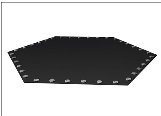
Die Sprungmembranen sind aus 6,0 mm dickem EP-Ethylen-Propylen-Förderband mit Polyester-Polyamidgewebe-Karkasse gefertigt. Die Federbefestigungen sind beidseitig mit Stahlbuchsen und Unterlegscheiben verstärkt. Die Membran ist ozonbeständig und mit 8 mittig angeordneten Wasserablauföchern ausgestattet.
