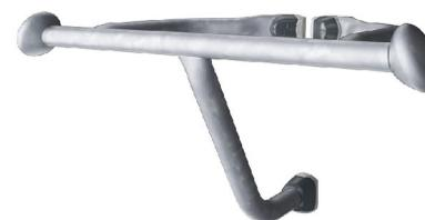
Der Stützgriff ist 530 mm breit. Der Griff befindet sich 1050 mm über dem Boden und 1140 mm über der Jumper Membran. Der Griff ist aus einer HDG-Stange mit einem Durchmesser von 32 mm gefertigt.
