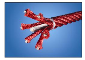
Les cordes Corocord de 19 mm de diamètre ou plus sont de type spécial «Hercules» avec des fils d'acier galvanisés à six torons. Chaque brin est étroitement enveloppé de fil PES. Les cordes sont reliées par des pinces en S en acier inoxydable qui sont pressées autour de la corde, ce qui se traduit par une solution durable et contre le vandalisme.
