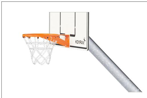
Le panier de basket est fabriqué en acier galvanisé à chaud avec un revêtement en poudre. Le filet est constitué de maillons de chaîne Ø4 en acier galvanisé s235 ou de chaînes en acier inoxydable qui répondent aux exigences des normes ISO1434-ISO1435 et DIN766. Les chaînes ont une circonférence de ~Ø30cm en bas et ~Ø50cm en haut.
