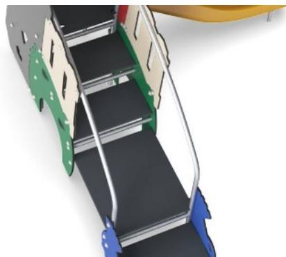
根据 EN 438-6，所有地板均由高压层压 HPL 制成，厚度为 17.8mm，表面防滑。KOMPAN HPL 具有很高的耐磨强度，可确保在所有气候下均具有较长的使用寿命。
