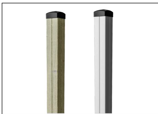
Los postes de torre principales están disponibles en dos tipos de materiales: postes de madera de pino europeo, impregnado a presión Clase 3 con Tanalith E3475 según EN335 (equivalente a NTR Clase AB). Poste de aluminio t=2mm con tratamiento superficial anodizado. Material base EN AW-6060 T66.
