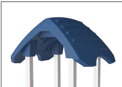
Los grandes componentes huecos están hechos de PE 100% reciclable. El techo exhibido está moldeado en una sola pieza con un espesor de pared mínimo de 5,5 mm para garantizar una alta durabilidad en todos los climas del mundo.
