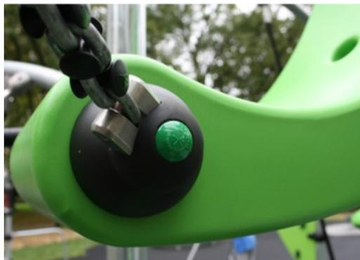
Las actividades más grandes están hechas de PE 100% reciclable. La carcasa de juego que se muestra está moldeada en una sola pieza con un espesor de pared mínimo de 5 mm. El PE tiene una alta resistencia al impacto en un amplio intervalo de temperatura que garantiza la resistencia al vandalismo en todas las ubicaciones.
