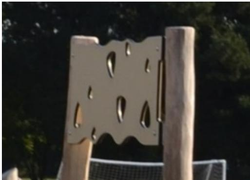
Kletterwand aus EcoCore™ (Dicke 19 mm). EcoCore™ ist ein besonders langlebiges, umweltfreundliches Material. Es kann nicht nur recycelt werden, sondern besteht - sowohl im Kern als auch in der bunten Außenschicht - aus +95 % recyceltem Post-Consumer-Material, z. B. aus Lebensmittelverpackungen.
