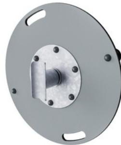
轴承屋是由热浸镀锌钢制成。轴承轴采用 AISI304 不锈钢制造。轴承本身由聚甲醛 (POM) 制成，聚甲醛是一种高刚度、低摩擦、尺寸稳定性好的工程热塑性塑料。
