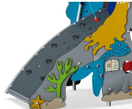
El muro de escalada curvo está hecho de Ekogrip panel que consiste en una base de PE de 15 mm de espesor con una capa superior de goma blanda de 3 mm con efecto antideslizante.
