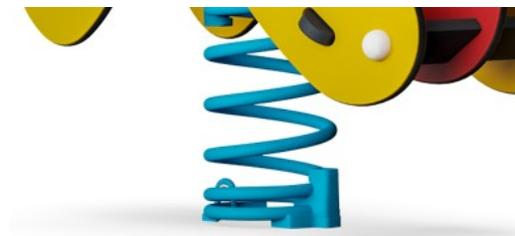
Les ressorts KOMPAN sont fabriqués en acier de haute qualité selon la norme EN 10270. Les ressorts sont nettoyés par phosphatation, avant d'être peints avec une amorce époxy et un revêtement thermolaqué de polyester en guise de finition. Les ressorts sont fixés par des raccords anti-pincement uniques pour une sécurité maximale et une longue durée de vie.
