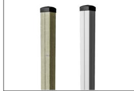
Die Pfosten der Haupttürme sind in zwei Materialausführungen erhältlich. Kiefernholz: Gemäß EN335 mit Tanalith (E 3475 Klasse 3) druckimprägniert. Aluminium mit einer Dicke von 2 mm und anodisierter Oberflächenbehandlung. Grundwerkstoff FN AW-6060 T66.
