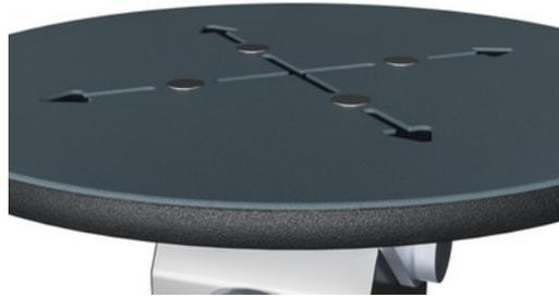
Die Deckplatte mit 414 mm Durchmesser besteht aus 15 mm Ekogrip®, einer 15 mm PE-Platte mit einer 3 mm dicken Deckschicht aus thermoplastischem Gummi mit Anti-Rutsch-Effekt. Die Höhe beträgt 217 mm und der Bewegungsbereich +/- 90°, mit einem Anschlag aus EPDM-Gummi an jedem Ende.
