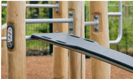
Die Oberfläche besteht aus Ekogrip™ Platten, die aus 15 mm Polyethylen mit einer 3 mm dicken Deckschicht aus thermoplastischem Gummi bestehen. Die Ekogrip™ Platten haben einen rutschfesten Effekt für komfortables und sicheres Training bei allen Wetterbedingungen.
