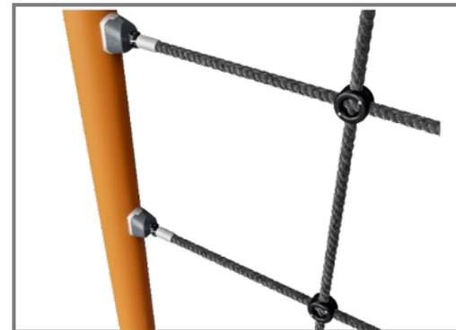
Die Seile bestehen aus UV-stabilisiertem PES mit innerer Stahlseilverstärkung. Das Seil ist induktionsbehandelt, um eine starke Verbindung zwischen Stahl und Seil zu schaffen, die zu einer guten Verschleissfestigkeit führt.
