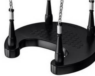
Il seggiolino curvo progettato da KOMPAN è realizzato con un inserto in compensato di 21,25 mm di spessore in legno di ontano e pino. Lo strato esterno è stampato in poliuretano stabilizzato ai raggi UV che mantiene le sue proprietà nell'intervallo di temperatura da -30 ° C a 60 ° C
