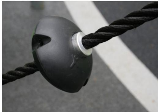
Die Galaxy-Seile verfügen über sechslitzige Stahldrahtseile, die mit einem Stahlkern versehen sind. Jede Litze ist mit PES-Garn umwickelt, das induktiv auf jede Litze aufgeschmolzen wird. Das PES-Garn besteht aus +95 % Post-Consumer-Material und ist äusserst beständig gegenüber Abnutzung und Vandalismus.
