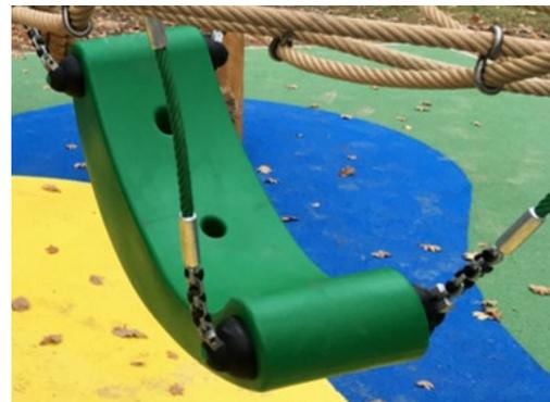
Le principali forme sono realizzate in PE a bassa densità stabilizzato UV riciclabile al 100%. Il guscio di gioco visualizzato è modellato in un unico pezzo con uno spessore minimo di 5 mm per garantire una lunga durata in tutti i climi del mondo.
