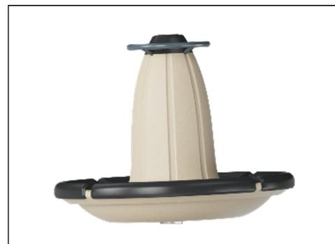
La parte central del Boogie Spinner es de polietileno (PE) reciclable fabricado con un 33% de materiales postconsumo y rotomoldeado en una sola pieza con casquillos roscados metálicos integrados y orificios de drenaje de agua para garantizar una gran durabilidad en todos los climas del mundo.
