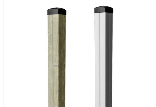
Hlavní sloupy věže jsou k dispozici ve dvou typech materiálu: Sloupy z evropského borovicového dřeva, tlakově impregnované Tanalitem E3475 třídy 3 podle EN335 (ekvivalent NTR třídy AB). Hliníkový sloupek t=2mm s eloxovanou povrchovou úpravou. Základní materiál EN AW-6060 T66.
