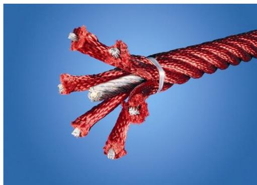
Les cordes Corocord d'un diamètre de 19 mm ou plus, sont des cordes spéciales de type « Hercules » dotées de torons de six brins d'acier galvanisé. Chaque toron est enveloppé hermétiquement dans du fil PES. Les cordes sont résistantes à l'usure et au vandalisme et peuvent être remplacées sur place si nécessaire.
