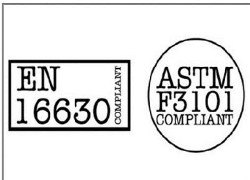
Tutti i prodotti per il fitness KOMPAN sono conformi agli standard di fitness outdoor ASTM F3101 e EN16630. I test di carico vengono eseguiti come test statici aggiungendo fattori dinamici e fattori di sicurezza al carico specificato di 78 kg per utente. Un prodotto destinato a 1 utente viene caricato con 420 kg.
