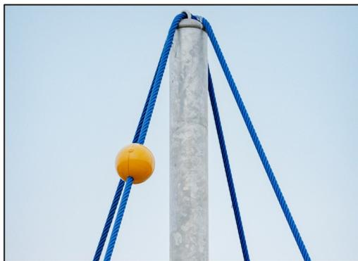
网的中心是桅杆，由高优质的无缝钢制成。桅杆对于游戏中的摇晃振荡提供支撑并且能保持攀爬网的结构平衡。桅杆使用标准的热镀锌材料，可选粉末涂料工艺。
