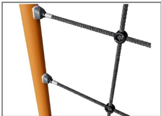
Las cuerdas Corocord de 16 mm son de tipo especial "Hércules" con alambres de acero galvanizado de cuatro hilos y un núcleo de alambre de acero. Cada hilo está bien envuelto con hilo PRES, que se funde con cada hilo individual. Las cuerdas son altamente resistentes al desgaste y al vandalismo y pueden reemplazarse en el sitio si es necesario.
