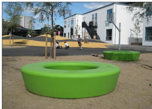
Les LOOPS peuvent être ancrés au sol en les remplissant d'eau ou de sable à l'aide des bouchons intégrés. Ils peuvent également être fixés à l'aide de supports de surface ou de sol.
