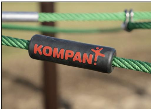
Des cordes fabriquées avec des torons PES résistants aux UV et dotées d'un câblage renforcé avec armature interne en acier. Le fil de polyester est réalisé avec plus de 95 % de matériaux post-consommation. Il est fondu par induction sur chaque toron, ce qui lui offre une excellente résistance à l'usure.
