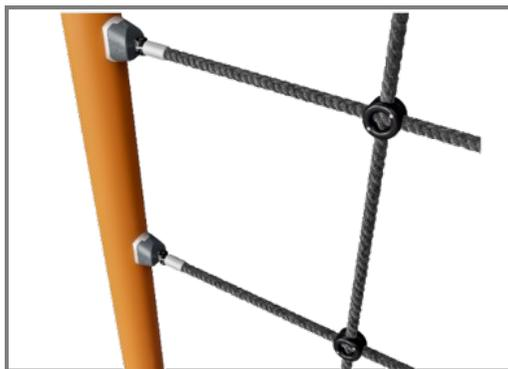
Corocord 16mm 绳索是特殊的“大力神”型绳索，具有镀锌四股钢丝和钢丝芯。每根钢丝束都用 PES 纱紧密包裹，然后将其融化到每根单独的钢丝束上。这些绳索具有很高的耐磨性和防破坏性，可以根据需要在现场更换。
