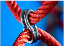
Die Corocord-S-Klemmen werden als universale Verbindungselemente für Corocord Produkte eingesetzt. 8 mm Stangen aus rostfreiem Edelstahl, mit abgerundeten Kanten werden mit einem hydraulischen Spezialwerkzeug auf die Seile gepresst und sind damit ideale Verbindungselemente: sicher, langlebig und vandalismusresistent, ohne dabei die typischen Bewegungen von Seilspielgeräten zu stören.
