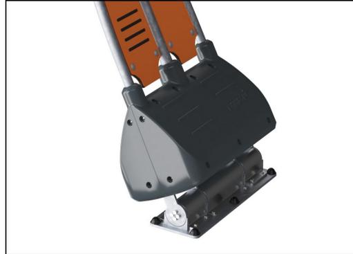
Il movimento oscillante avanti e indietro è controllato da un elemento a molla di torsione in doppia gomma graduata per impieghi gravosi. L'elemento in gomma garantisce un movimento sicuro e riduce la velocità verso le piattaforme della torre. La copertura della base è in PE stampato ad alta resistenza agli urti.
