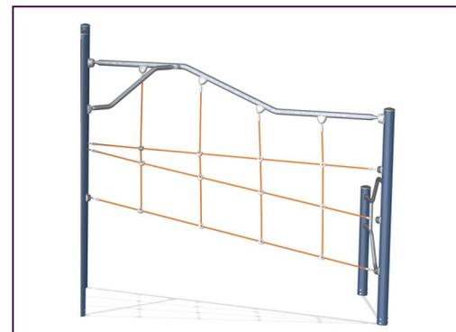
Die ELEMENTS™ Seile verfügen über sechslitzige Stahldrahtseile, die mit einem Stahlkern versehen sind. Jede Litze ist mit PES-Garn umwickelt, das aus +95 % Post-Consumer-Material besteht. Das Garn wird induktiv auf jede einzelne Litze aufgeschmolzen, was die Seile äusserst beständig gegenüber Abnutzung und Vandalismus macht.
