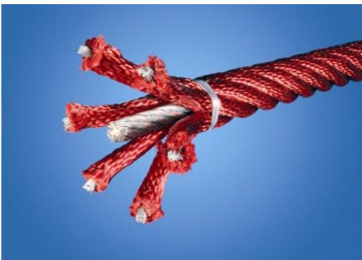
Las cuerdas de Saturno tienen alambres de acero de seis hilos y un núcleo de alambre de acero. Cada hilo está bien envuelto con hilo PES, que se funde con cada hilo individual. Después de que la fricción inicial haya eliminado las fibras de la superficie, queda un revestimiento de PES más duro para proteger cada hebra, haciendo que las cuerdas sean altamente resistentes al desgaste y al vandalismo.
