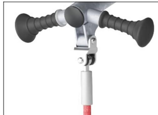
Las dos asas superiores anguladas están hechas de un inserto de PP moldeado con una capa externa suave de caucho TPV. El mango está unido al poste con una incrustación de acero galvanizado para garantizar su resistencia y durabilidad.
