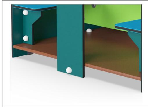
El suelo está hecho de madera contrachapada de 21,5 mm de espesor hecha de aliso y madera de pino. Ambos lados están cubiertos por 2 capas de película fenólica con patrón de red antideslizante. Todos los bordes de corte están sellados con pintura para garantizar una larga vida útil.
