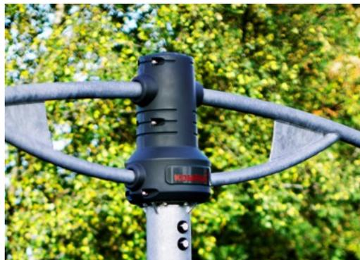
Sistema di cuscinetti progettato per impieghi gravosi con cuscinetti radiali a una corona di sfere con tenute in gomma. La struttura del cuscinetto completamente chiusa è lubrificata a vita e non richiede manutenzione.
