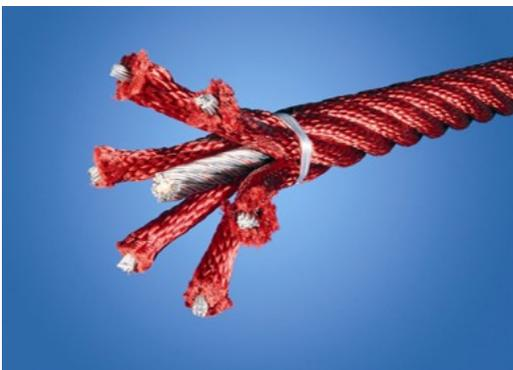
Le corde Saturno sono rivestite da un nucleo e sei fili di acciaio inossidabile. Ogni filo è strettamente avvolto con filo PES, che viene poi fuso su ogni singolo filo. Dopo che l'attrito iniziale ha rimosso le fibre superficiali, rimane un rivestimento PES più duro per proteggere ogni filo, rendendo le corde altamente resistenti all'usura e agli atti vandalici.
