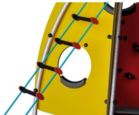
Die Netze und Seile bestehen aus starkem UV-beständigem PA mit innerer Seilverstärkung. Die Seile sind induktionsbehandelt, um die Verbindung zwischen Stahl und Seil zu stärken und für eine hohe Verschleißfestigkeit des Seils zu sorgen.
