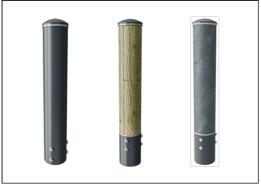
具有热浸镀锌钢脚的主立柱有不同的材料可供选择:压力浸渍松木立柱;在内外部进行了预镀锌处理,顶部涂有粉末涂层的钢柱;无铅铝,表面阳极氧化处理。
