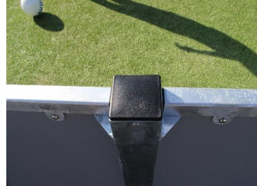
Die Pfosten sind aus 80 x 80 x 3 mm Querschnitten mit horizontal geschweißten 6 mm Flanschen gefertigt. Dies ermöglicht eine einfache Montage und eine stabile Konstruktion. Die Polyethylen Kappen auf den Pfosten sind mit Blindnieten befestigt.
