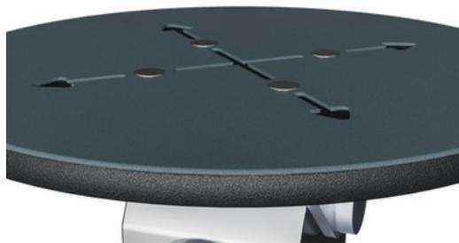
La placa superior de 414 mm está hecha de Ekogrip de 15 mm, una placa de PE de 15 mm con una capa superior de caucho termoplástico de 3 mm con efecto antideslizante. La altura es de 217 mm y el rango de movimiento es de +/- 90, con un tope de goma EPDM en cada extremo.
