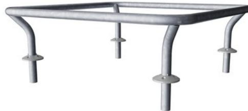
El pasamanos diseñado como agarre durante los ejercicios está hecho de acero galvanizado en caliente de 38 mm, un gran diámetro para un buen agarre y para apoyar la muñeca. La altura del pasamanos es de 940 mm desde la parte superior de la placa HPL. La distancia entre los rieles es de 900 mm.
