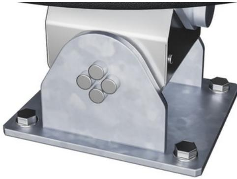
El elemento doble ROSTA está hecho de hierro fundido y galvanizado en caliente antes de pintarlo. Esto asegura que el elemento ROSTA sea una junta elástica sin mantenimiento que se puede mover en un rango de movimiento de 250 en cualquier dirección. Ambas oscilaciones tienen una rigidez diferente, la diferencia es del 45%.
