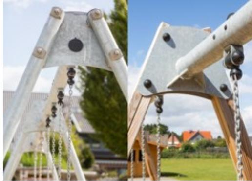
A 型框架的设计是采用热浸镀锌  $\phi 100\text{mm}$  横杆和大型钢制端板，以牢固固定两个接杆选项：热浸镀锌  $\phi 70\text{mm}$  钢。浸渍松木，带热浸镀锌钢底座。
