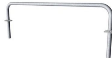
El pasamanos diseñado como agarre durante los ejercicios está hecho de acero galvanizado en caliente de 38 mm, un gran diámetro para un buen agarre y para apoyar la muñeca. La altura del pasamanos es de 940 mm desde la parte superior de la placa HPL. La distancia entre los rieles es de 900 mm.
