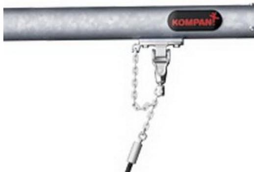
Odolné houpačkové závěsy KOMPAN z nerezové oceli s anti-twist funkcí. Závěsy jsou připevněny k příčnému nosníku na svařované konzole se dvěma šrouby. Ložiska jsou zabudována se silikonovým mazivem a nepotřebují další mazání.
