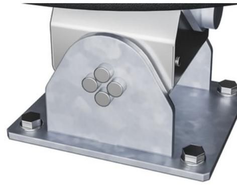
Il doppio elemento ROSTA è realizzato in ghisa e zincato a caldo prima della verniciatura. Ciò garantisce che l'elemento ROSTA sia un giunto elastico esente da manutenzione che può essere spostato nel raggio di movimento di 250 in qualsiasi direzione. Entrambe le oscillazioni hanno una rigidità diversa, la differenza è del 45%.
