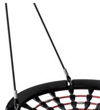
Crochets de suspension KOMPAN robustes en acier inoxydable avec fonction anti-torsion. Les cintres sont fixés à la traverse sur un support soudé avec deux boulons, les roulements sont intégrés avec du lubrifiant silicone et ne nécessitent aucune lubrification supplémentaire.
