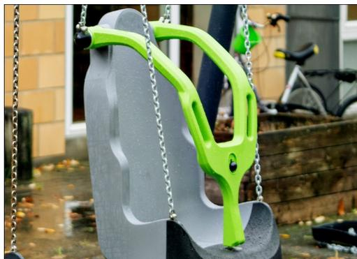
El arnés está fabricado con polietileno (PE) reciclable moldeado a partir de un 33% de materiales postconsumo. El arnés utiliza un resorte de torsión de acero inoxidable que hace que el arnés permanezca en todas las posiciones para asegurar una entrada y salida más fácil de los usuarios. El cierre del arnés está diseñado con un deslizador de operación con una sola mano hecho de acero inoxidable.
