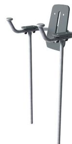
Le cadre de l'élevateur de jambe est en tube d'acier HDG Ø38 x 2 mm. Les plaques de support sont en Ekogrip® de 15 mm, une plaque en PE de 15 mm avec une couche supérieure de 3 mm de caoutchouc thermoplastique à effet antidérapant. Les supports de bras mesurent 110 x 195 mm, espacés de 580 mm et 1315 mm au-dessus du sol. Le support dorsal mesure 335 x 500 mm. L'ouverture à l'arrière est de 30 x 350 mm.
