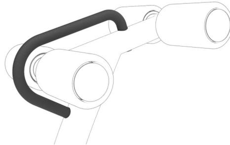
Die Bank hat einen Stützgriff mit einem Durchmesser von  $\varnothing 30$  mm. Der Stützgriff erleichtert das Auf- und Absteigen von der Bank und ermöglicht eine Variation der Übungen. Die Pulverbeschichtung, die auf dem Stützgriff verwendet wird, ist sehr widerstandsfähig gegen Abnutzung und Verschleiß, bietet Isolierung und gibt dem Benutzer gleichzeitig einen hervorragenden Halt während des Workouts.
