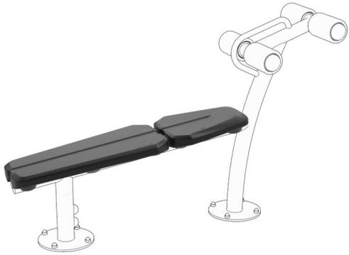
Der Sitz und die Rückenlehne bestehen aus Polyurethan-Gummi (PUR) und haben eine verzinkte Stahlplatte, die den Sitz mit dem Stahlrahmen verbindet. Sie sind in einem 8-Grad-Winkel angeordnet, um die richtige Ergonomie zu gewährleisten. Die Rückenlehne hat eine Aussparung, um die Wirbelsäule zu entlasten, eine bequeme Sitzposition zu ermöglichen und Wasser abfließen zu lassen.
